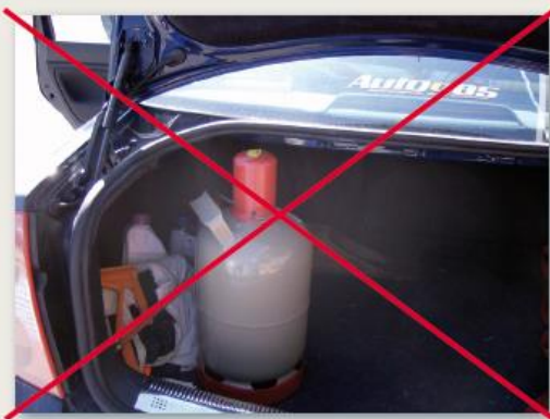
So nicht: Ladegutsicherung fehlt!
