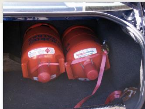
Wenn liegender Transport, dann mit Gurt befestigen und nur mit Kappe, egal ob volle oder leere Flaschen!
